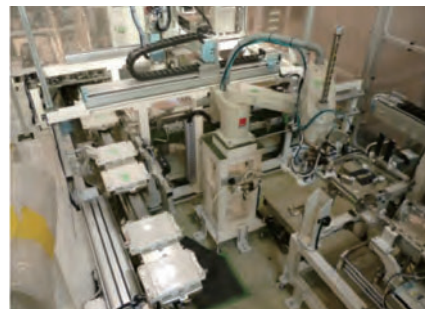
リチウムイオン電池組立設備
